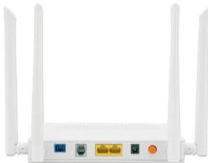
Terminal óptico de red (ONT) para la recepción de datos a través de fibra óptica. Ideal para acceso de banda ancha, conectividad WiFi (AC) y telefonía.
